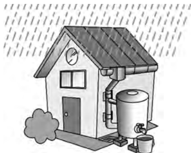
雨水貯留施設
