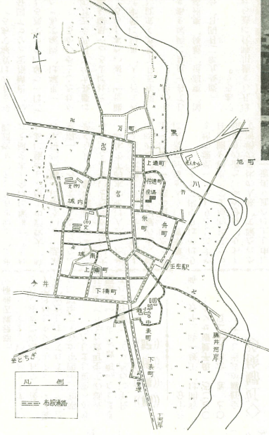
壬生町地内、水道配水管布設計計画
